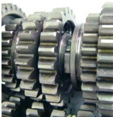
azionano le forchette che a loro volta spostano le ruote dentate lungo i propri alberi creando l'innesto del rapporto. I 2 ingranaggi che vanno a formare la marcia inserita si agganciano letteralmente tramite alcuni denti ricavati sui fianchi che si innestano nelle corrispondenti cavità (da qui la denominazione di innesti frontali).
