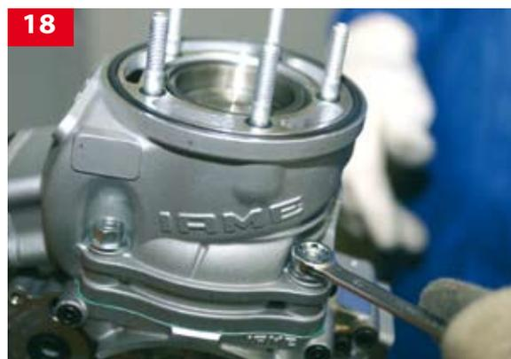
**18 - Cilindro.** 4 dadi M8 chiave combinata da 12 mm per ragioni di interferenza tra chiave e corpo cilindro. Alla base è collocata una guarnizione in materiale sintetico. Rispetto al Tag X30, sempre Parilla, il cilindro ha una fusione più complessa, con un'intercapedine di raffreddamento che meglio avvolge le parti termicamente sollecitate, e che consente una circolazione completa e ottimale. La canna cilindro, riportata, è di ghisa centrifugata.
