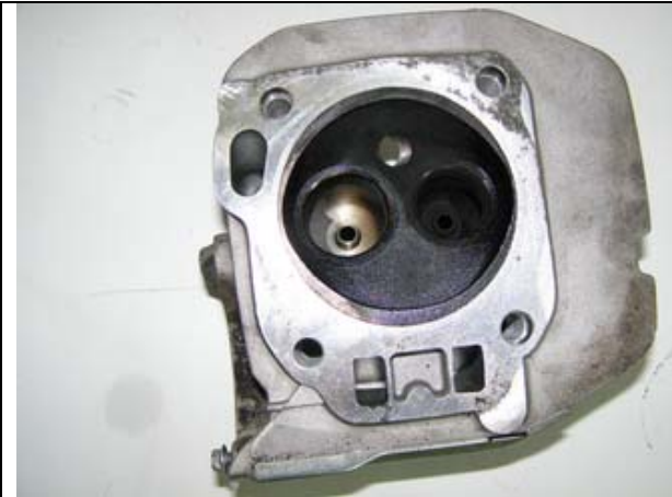
Фото: Головка цилиндра - вид камеры сгорания
