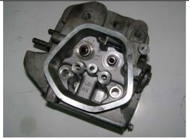
Фото: Головка цилиндра - вид сверху
