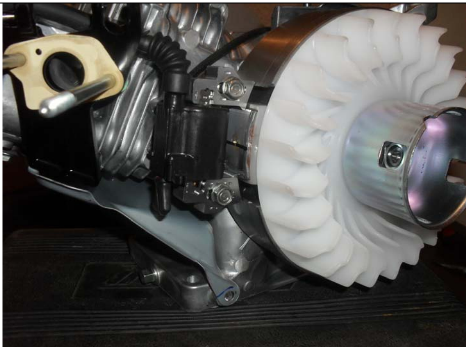
Положение элементов зажигания в 25^\circ до ВМТ коленвала
