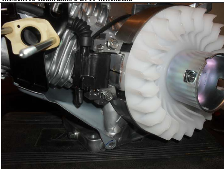
Положение элементов зажигания в 25° до ВМТ коленвала
