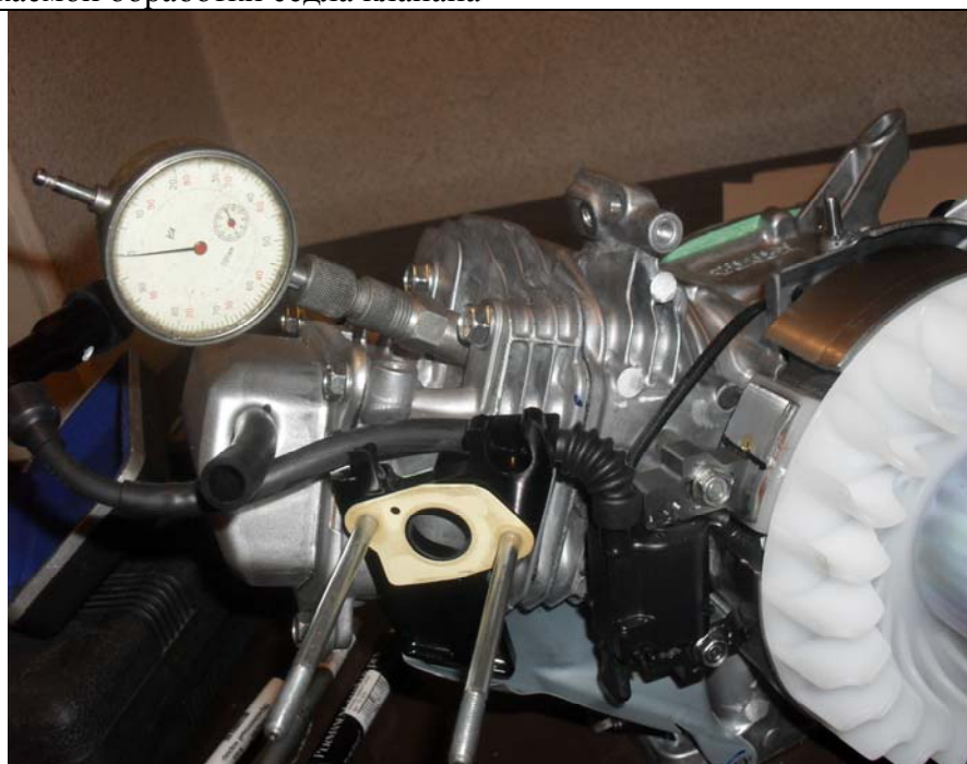
Положение элементов зажигания в ВМТ коленвала
