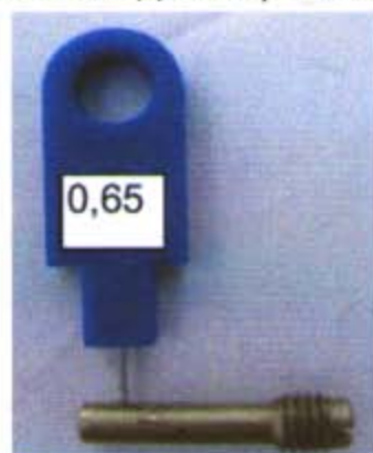
15.8.3.8. Запорная игла поплавковой камеры "150". На игле должна быть маркировка INC
