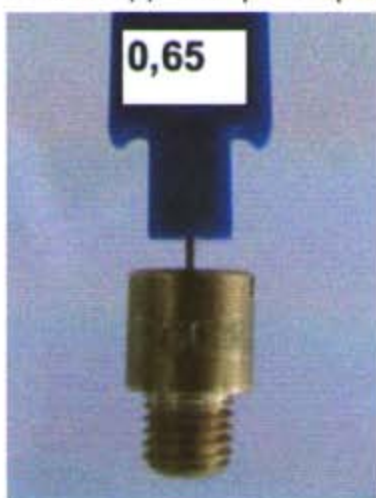
15.8.3.5. Диаметр отверстия 0,65 мм тах
