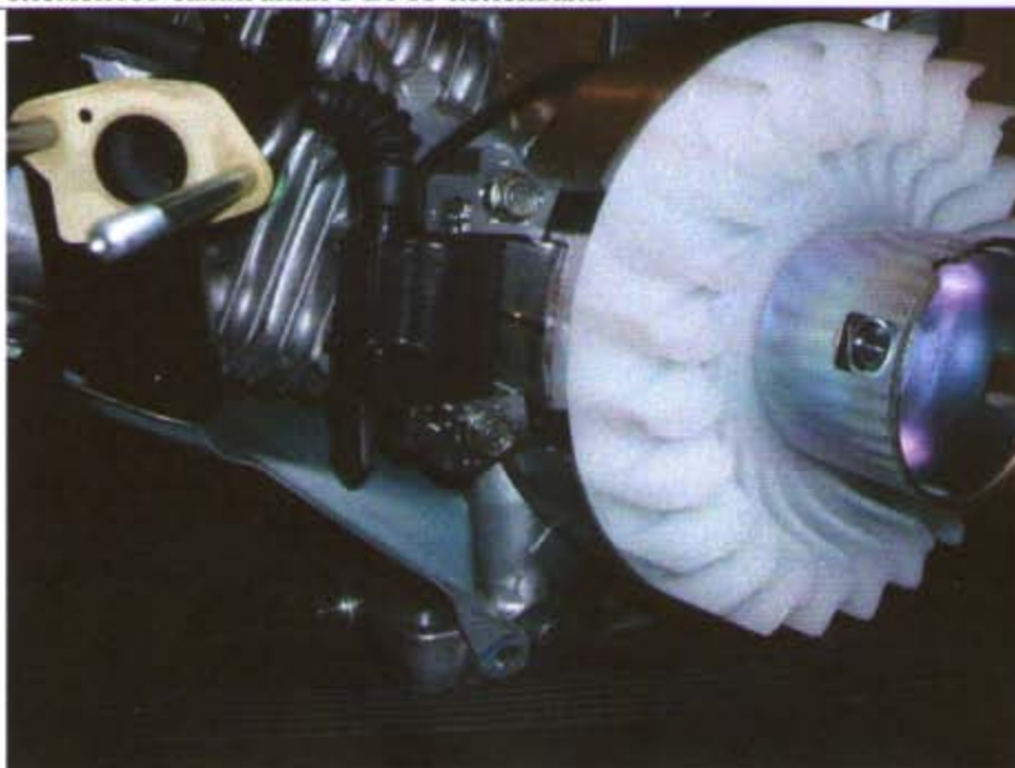
Положение элементов зажигания в 25° до ВМТ коленвала
