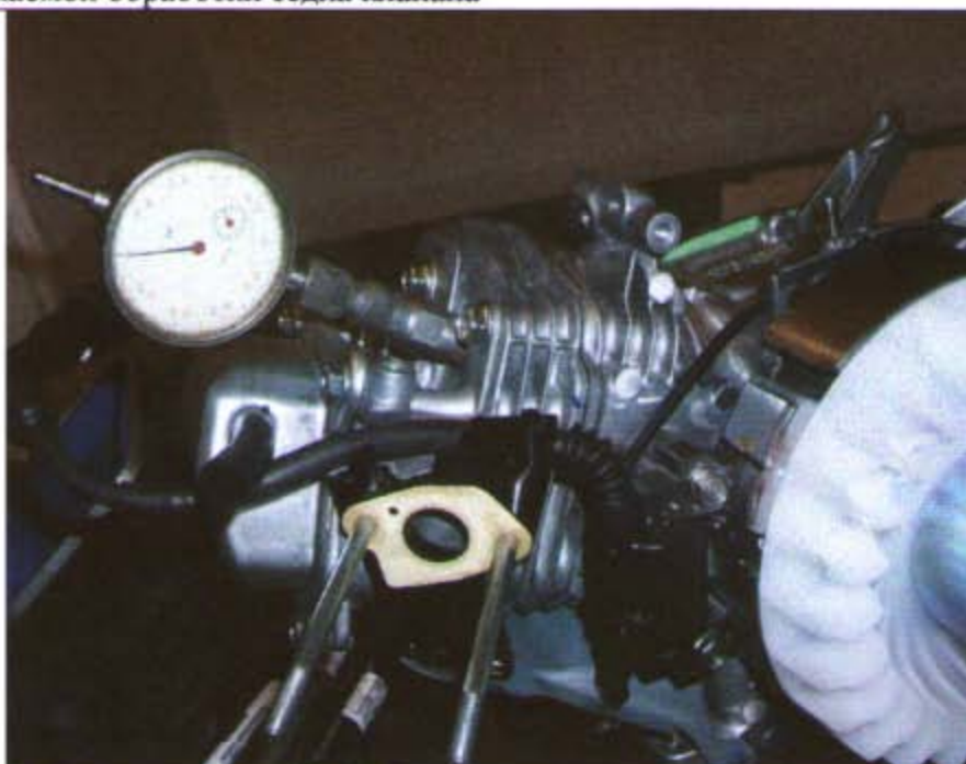
Положение элементов зажигания в ВМТ коленвала
