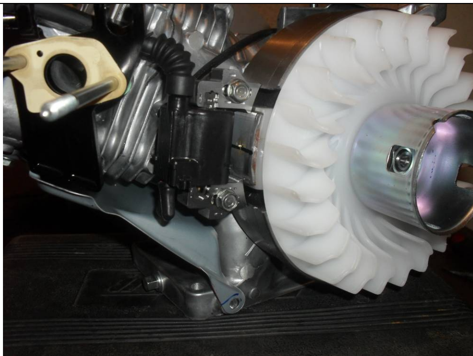
Положение элементов зажигания в 20° до ВМТ коленвала
