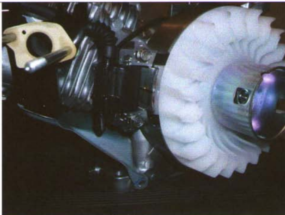
Положение элементов зажигания в 20° до ВМТ коленвала
