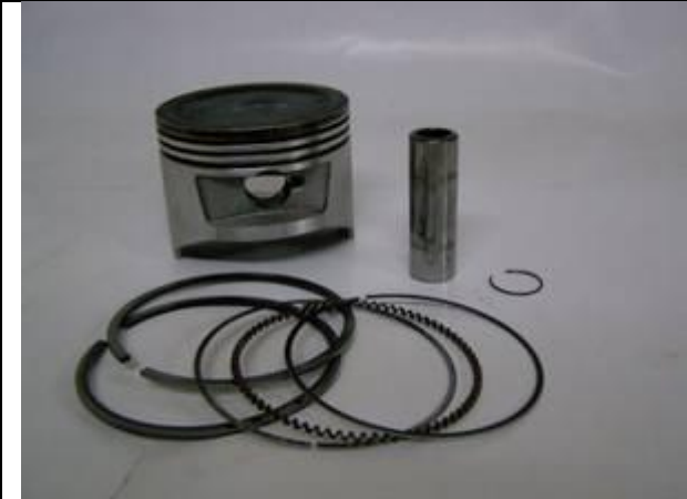
Фото: Поршень, кольца, палец и стопора
