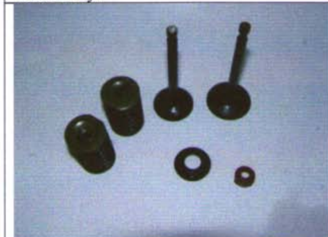
Фото: клапаны, пружины, тарелки, шайбы
