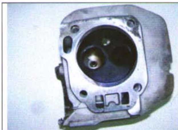
Фото: Головка цилиндра - вид камеры сгорания
