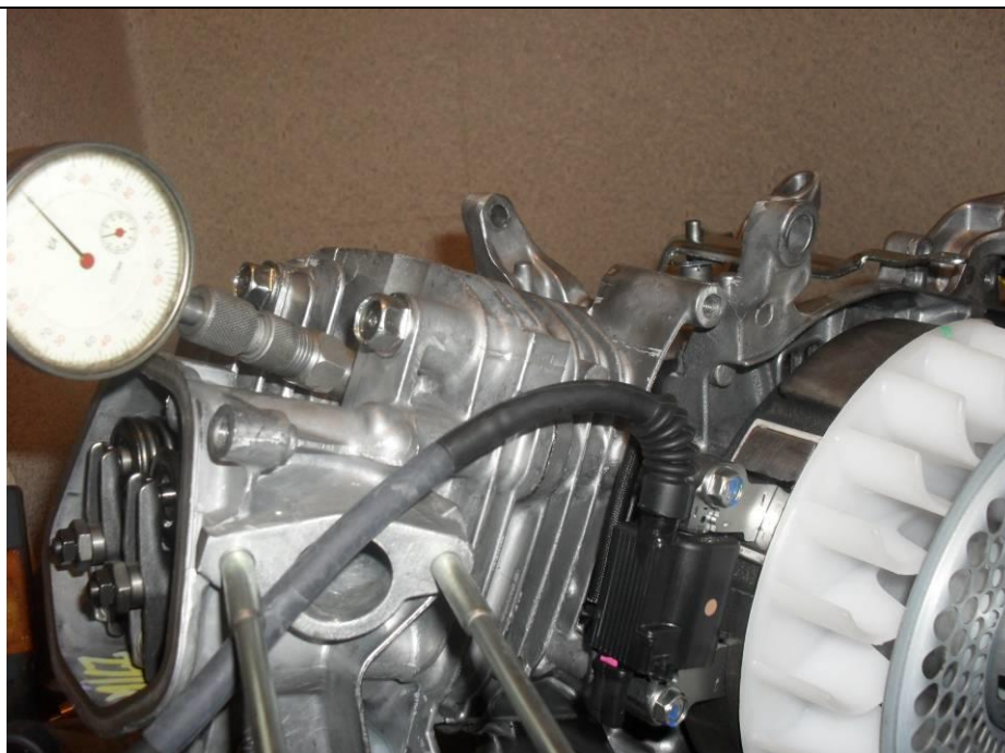
Положение элементов зажигания в ВМТ коленвала
